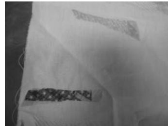
그림 7. 친환경성 소재에 로고 접착이 실패한 사진
