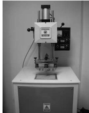
그림 6. 실험에 사용한 진공관 고주파 유전자열장치
